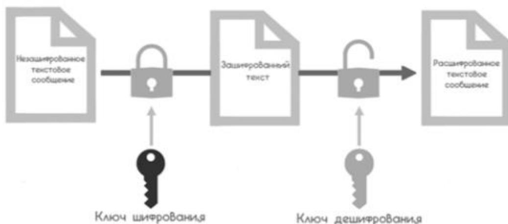
Рисунок 2. Асимметричное шифрование
