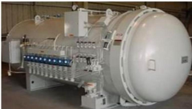
*Рисунок 1. Автоклав для изготовления изделий из ПКМ*
